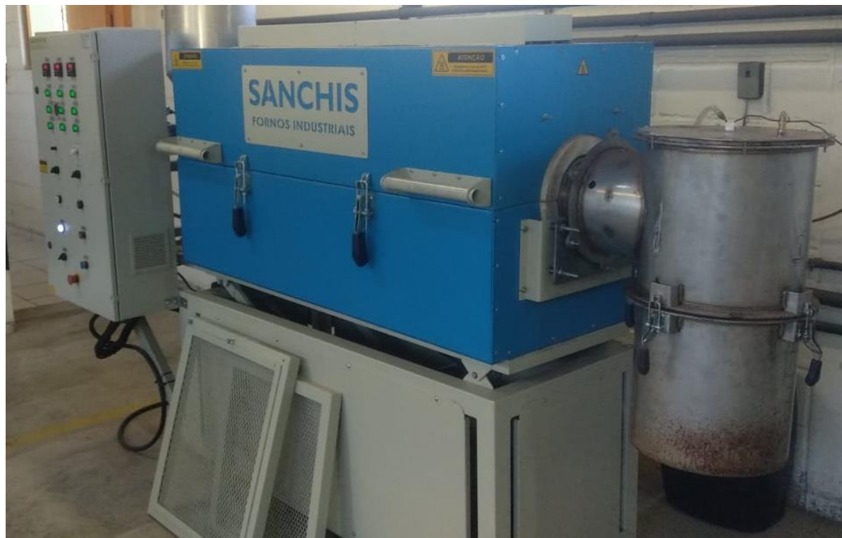
Figura 38 Foto do forno finalizado e instalado na planta piloto
