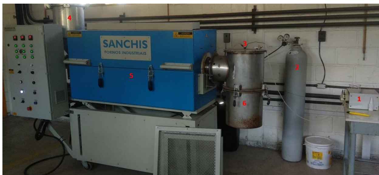
Figura 39 1-Bomba peristáltica; 2-Cilindro de N 2 ; 3-Entrada de gás; 4-Entrada de material; 5-Reator; 6-Armazenamento
