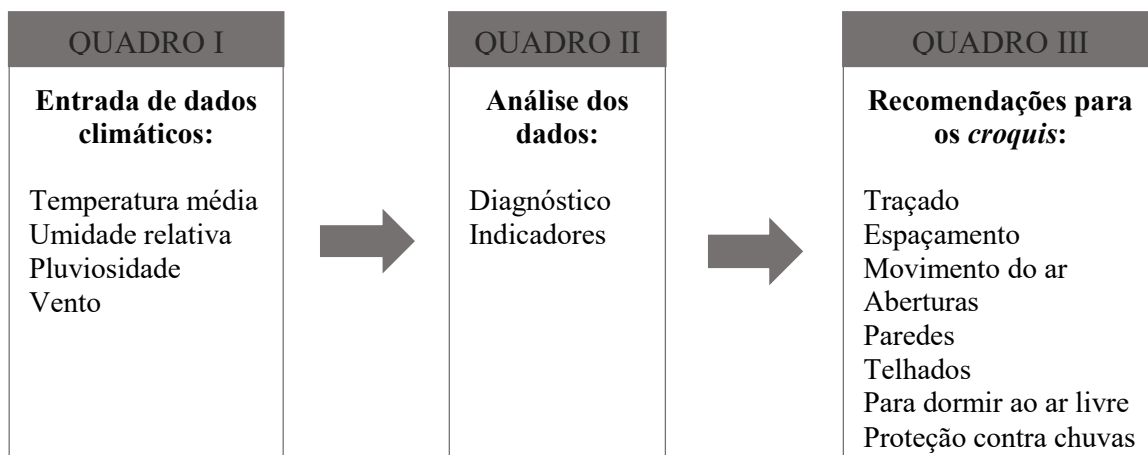
Figura 4: Estrutura geral da metodologia de Mahoney, segundo KOENIGSBERGER et al. ,1977 Fonte: adaptado de HARRIS, CHENG e LABAKI, 2000
