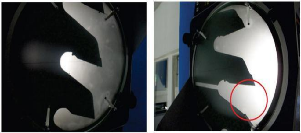
Figura 5 - Comparativo entre os perfis dos dentes novos e após o uso.
