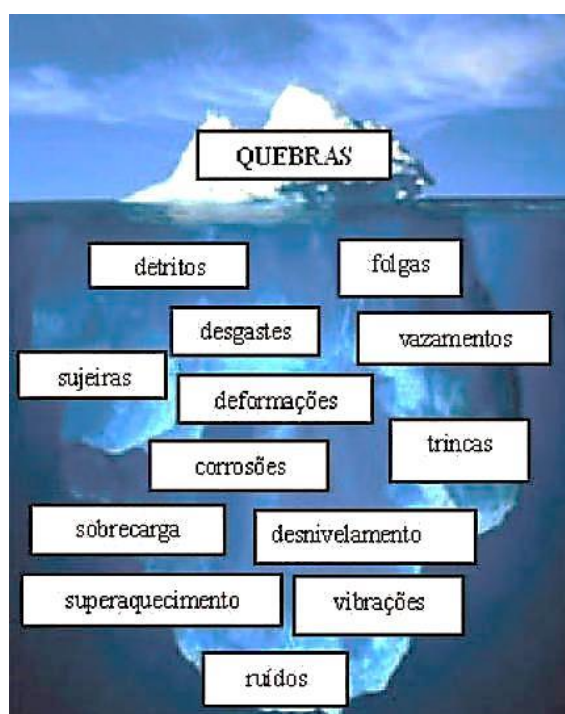
Figura 1 - Fatores que levam à quebra do equipamento.
