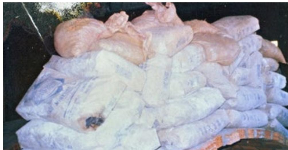
Escola de Engenharia da UFOP: Prova de carga em abóbada (processo construtivo CETEC)
