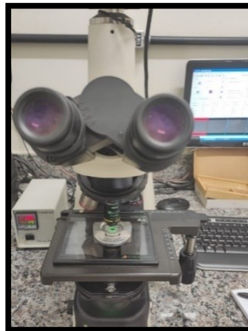
Figura 3. Sistema CASA: microscópio óptico com câmara acoplada e câmara de Makler
