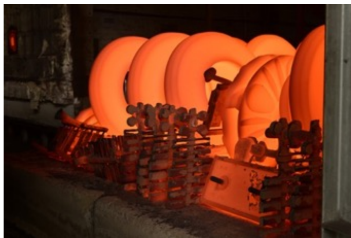
Figura 5.7 – Detalhe das amostras fundidas após abertura do forno ao final da manutenção da temperatura de austenitização. [produzida pela Metalúrgica Soares]
