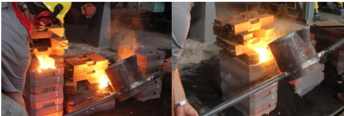
Figura 5.2 – Fusão da liga sem nióbio e boro (Cr-CI) e da Liga com nióbio (CrNb-CI) e preenchimento dos moldes.
