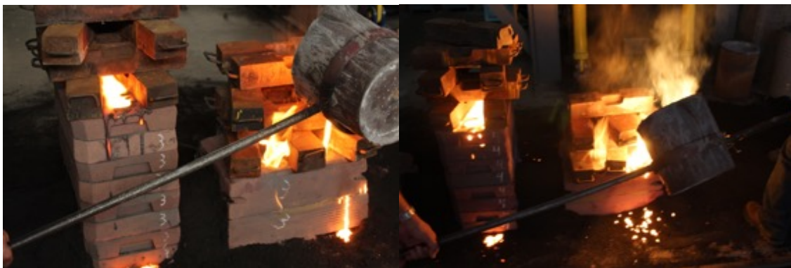
Figura 5.3 – Fusão da Liga com boro (CrB-CI) e da Liga com boro e nióbio (CrNbB-CI) e preenchimento dos moldes.
