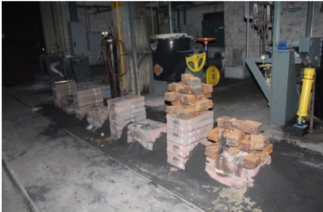
Figura 5.4 – Retirada dos contrapesos para desmoldagem das placas e amostras.
