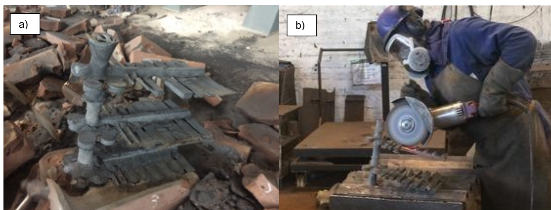
Figura 5.5 – (a) desmoldagem das amostras e (b) rebarbação.
