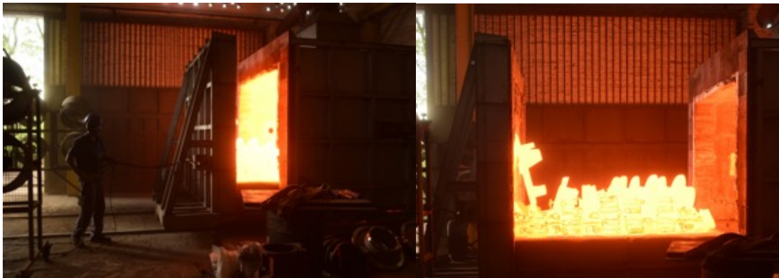
Figura 5.6 – Início da abertura do forno após o ciclo de austenitização. [produzida pela Metalúrgica Soares]
