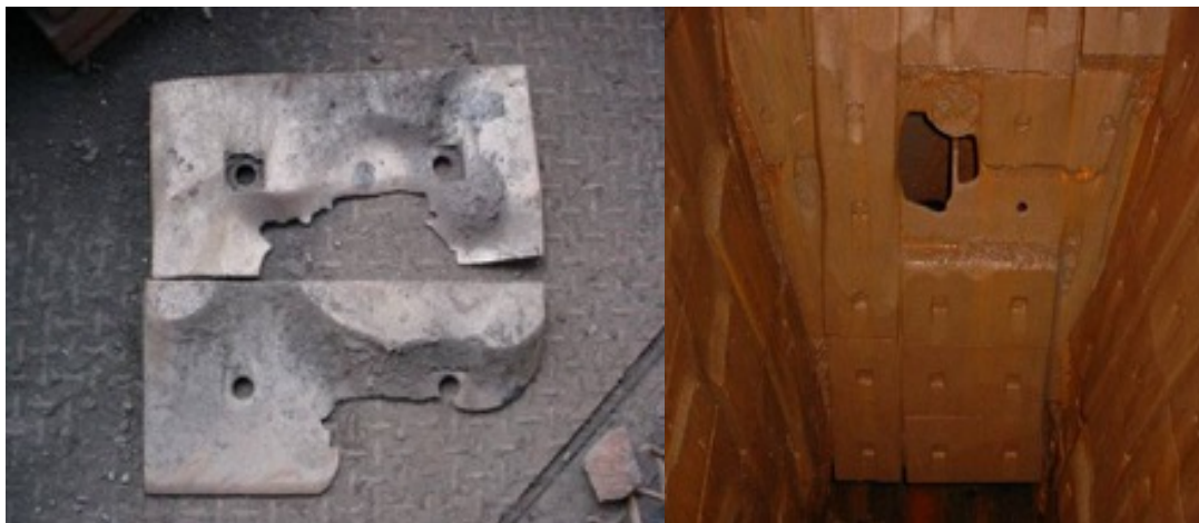
Figura 1.1 – Placa de desgaste em ferro fundido branco alto cromo para revestimento de chute de transferência de minério de ferro após 15 dias de operação. [OLIVEIRA, 2015, p. 24]
