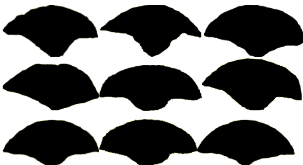
Figura 4.8: Perfis de alguns cordões. Fonte: o autor, 2020.
