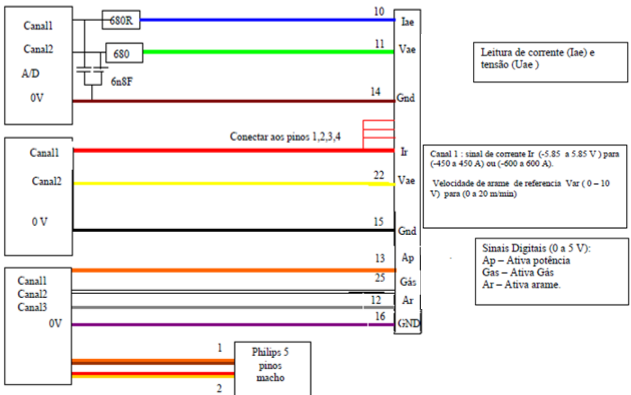
Figura 3.5: Diagrama dos sinais elétricos da fonte de soldagem. Fonte: (IMC-Soldagem, 2019).
