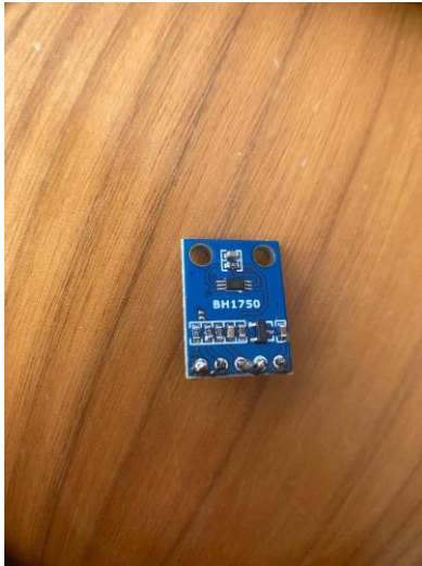
Figura 17 - Sensor de luz bh1750
