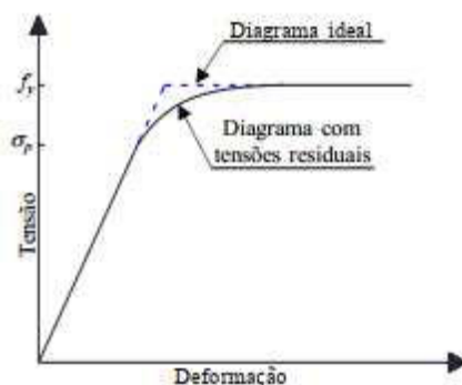
Figura 2.40 – Influência das tensões residuais no diagrama tensão versus deformação (GRILO, 2018).
