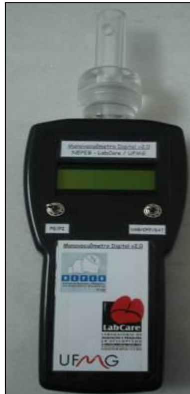
Figura 1: Manovacômetro digital utilizado durante as avaliações, desenvolvido pelo Núcleo de Estudos e Pesquisa em Engenharia Biomédica (NEPEB/UFMG) em parceria com o LabCare/UFMG (Belo Horizonte - MG, Brasil).
