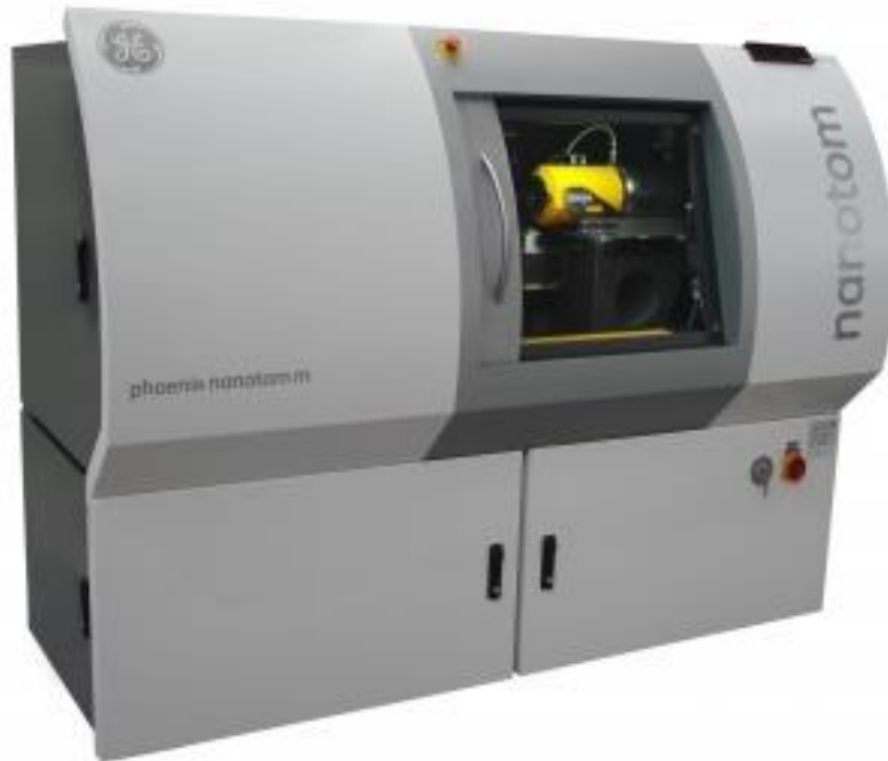
Figura 32. Tomógrafo Nanotom 160 kV, fabricante GE (Phoenix).
