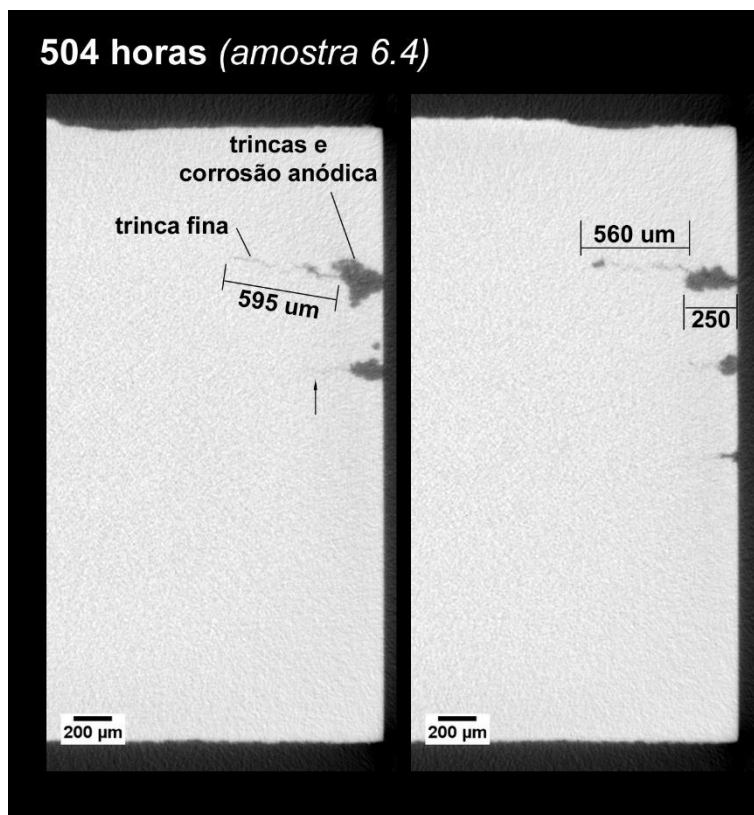
Figura 69. Sequência de seções longitudinais obtidas por XRT de parte do volume da amostra 6.4.
