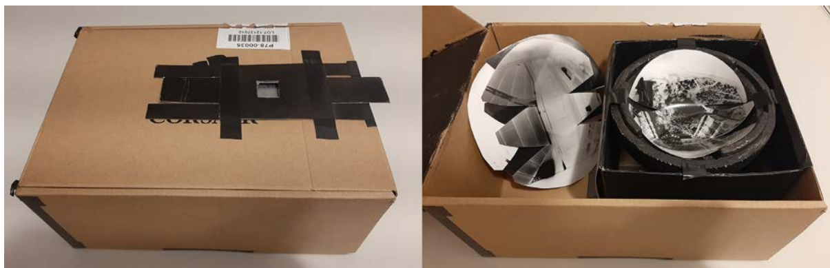
Imagem 43 – Câmera estenopeica ( pin-hole ) projetada para produção de imagens dômicas com papel fotográfico recortado para ajuste no globo de isopor. Fotos do autor.
