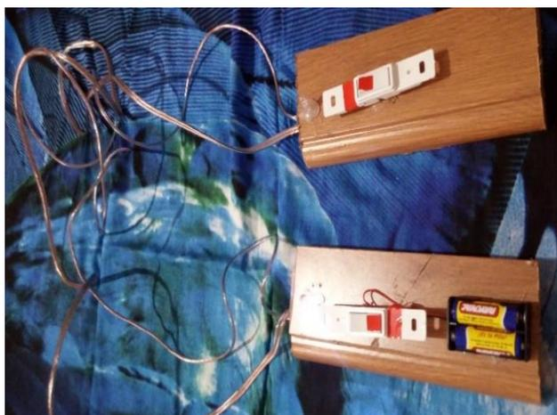
Telégrafo adaptado e construído pelo pesquisador para uso em sala de aula.
