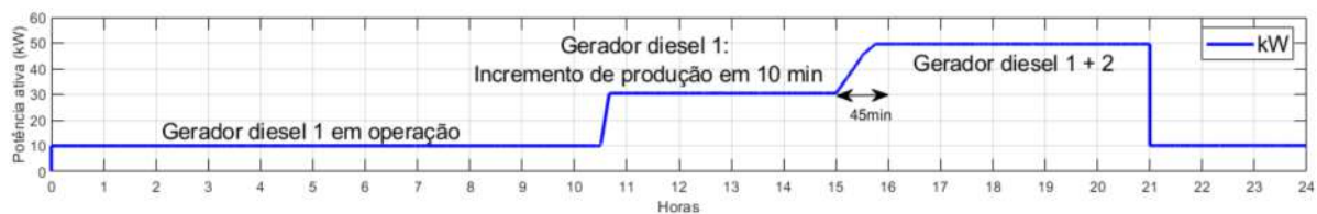
Figura 34 – Perfil de potência ativa dos geradores diesel da microrrede de BT.
