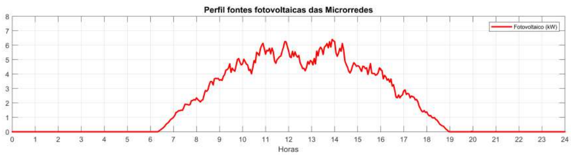
Figura 29 – Perfil de geração de potência ativa das fontes fotovoltaicas da microrrede 1.
