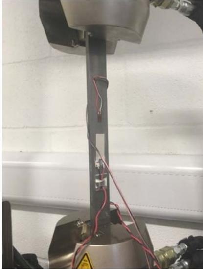
Figura 4: Montagem experimental para medição de deformação cíclica de barra metálica por sensor de PVDF. Fonte: Fotouhi ( 2019 )
