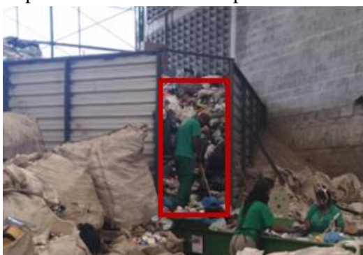
Figura 35 – Cooperado da equipe de apoio puxando material do silo para a esteira.
