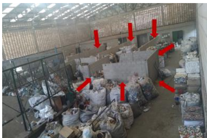
Figura 20 – Paredes no meio do galpão prejudicando o trânsito de materiais.
