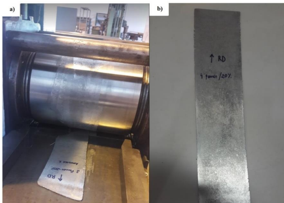
Figura 37- Laminação do Mg comercialmente puro. (a) Mg passando através dos rolos de laminação e (b) Mg após o seu processamento.
