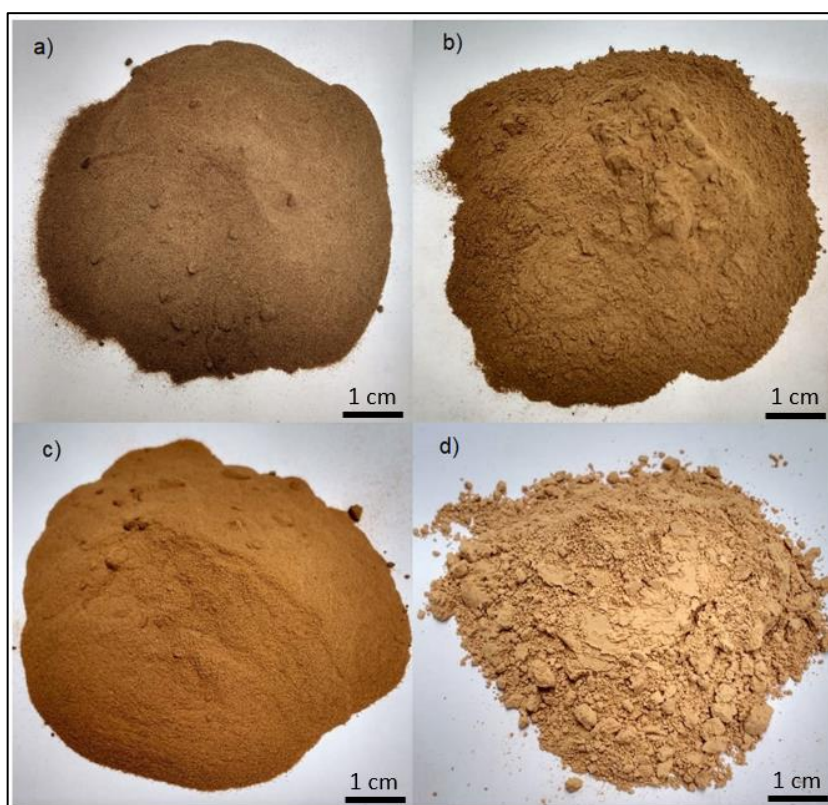
Figura 5.1 - Fotos das amostras a) Rejeito in natura (IN), b) Rejeito in natura moagem primária (INMP), c) Rejeito rico em sílica moagem primária (RSMP) d) Rejeito rico em sílica moagem secundária (RSMS).
