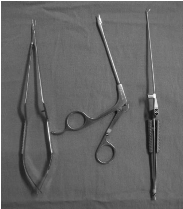
Fig. 2 Tipos de microtesoura. À esquerda, a microtesoura clássica desenhada por Yasargil e usada na microcirurgia. A forma em baioneta impede que a mão do cirurgião obscureça sua visão. A fim de permitir a pega em pinça, com o polegar em oposição ao segundo e terceiro dedos, o instrumento é largo. Contudo, isto não é um problema pois o túnel de acesso ao campo também é largo. No centro, a tesoura usada na endoscopia nasal. Observa-se que a haste é fina, propiciando passagem por túnel estreito. A maneira de pegar e manusear o instrumento é por meio das argolas da empunhadura. À direita, a nova microtesoura que tem todas as vantagens das anteriores: haste fina e pega em forma de pinça que propicia o manuseio mais preciso.
