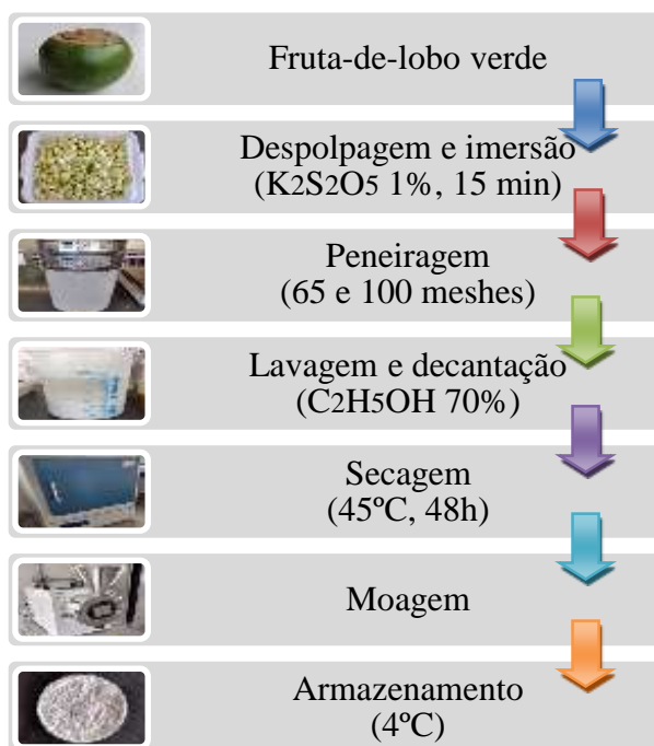
Figura 1 – Método de obtenção do amido de fruta-do-lobo.
