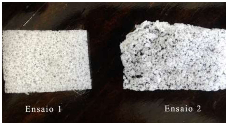
Figura 1 – Espumas poliméricas à base de amido de milho, Ensaio 1 e 2, respectivamente.
