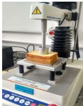
Figura 01– Fotografia dos pães elaborados e avaliação do perfil de textura em texturômetro instrumental
