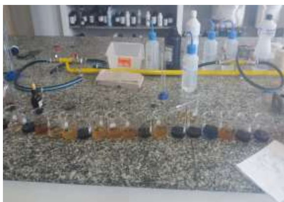
Figura 03 – Fotografias das amostras de mel após reação de Lugol. Amostras com coloração do azul ao preto indicam méis fraudados.
