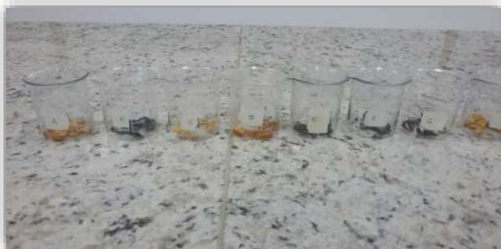
Figura 1 - Identificação da presença de amido em amostras de requeijão manteiga
