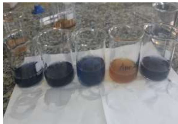
Figura 03 – Fotografias das amostras de mel após reação de Lugol. Amostras com coloração do azul ao preto indicam méis fraudados.
