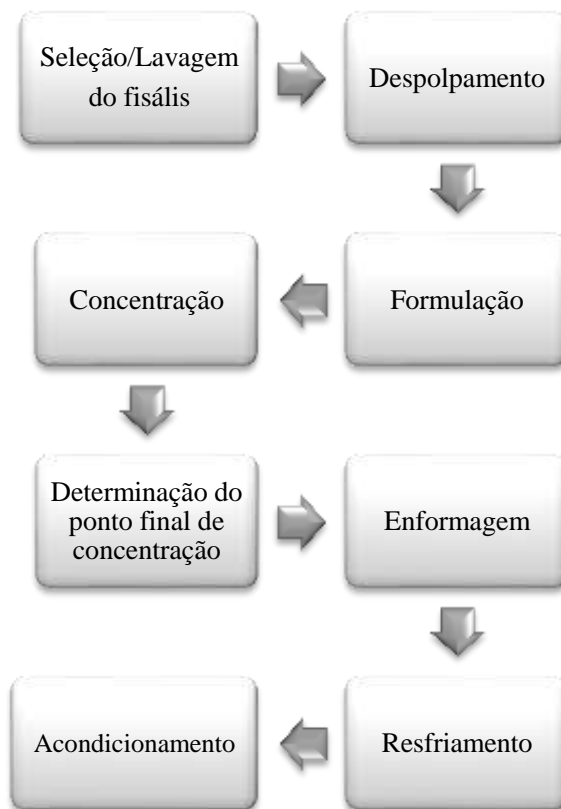
Figura 1 - Fluxograma do processo de fabricação do Doce em Massa
