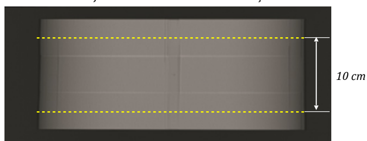
Figura 3.9 - Scout frontal do objeto simulador P8 com indicação dos limites de varredura.
