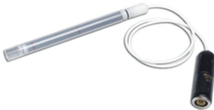
Figura 3.5 - Câmara de ionização RADCAL ACCU-GOLD modelo 10X6-3CT.
