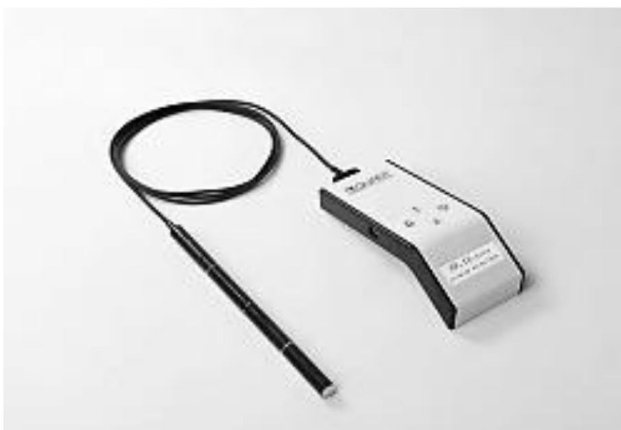
Figura 2.9 - Câmara de ionização tipo lápis.
