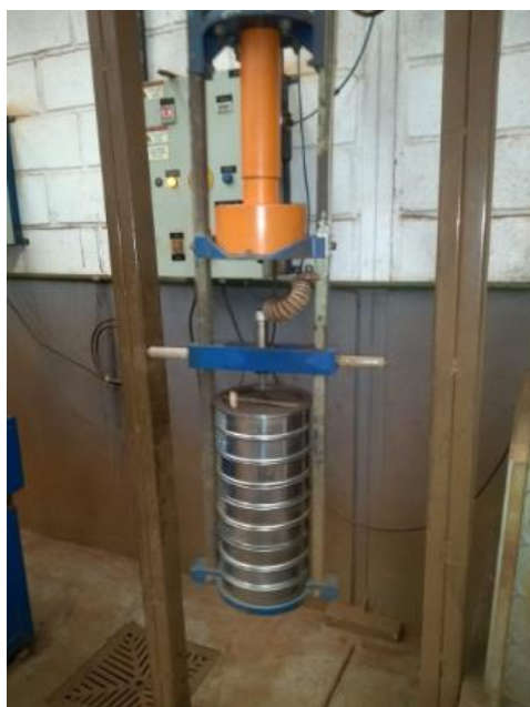
Figura 4.3 – Procedimento de classificação granulométrica: conjunto de peneiras inseridas no sistema de vibração.
