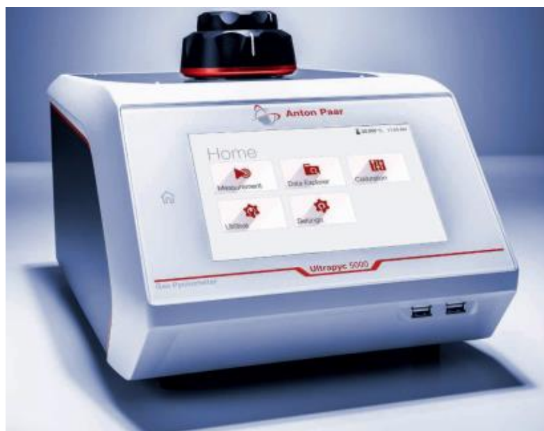
Figura 4.12 – Picnômetro a gás, série Ultrapyc modelo 5000 da marca Anton Paar (Anton Paar, 2020)
