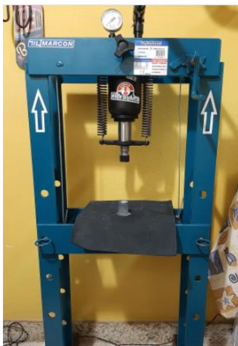
Figura 4.6 – Fotografia da prensa hidráulica utilizada na compactação dos resíduos
