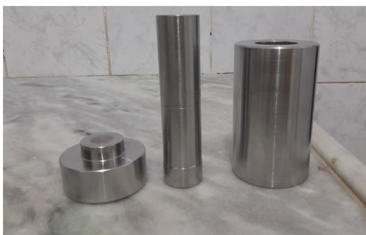
Figura 4.7– Fotografia das peças componentes do cilindro molde utilizadas na fabricação dos briquetes
