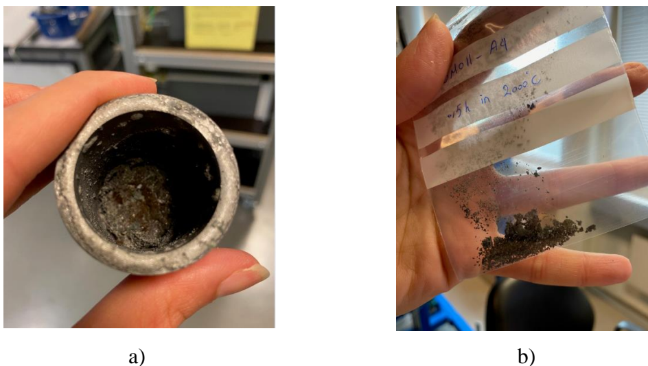
Figura 4.16 – a) Material fundido dentro do cadinho de grafite; b) Material fundido coletado do cadinho de grafite
