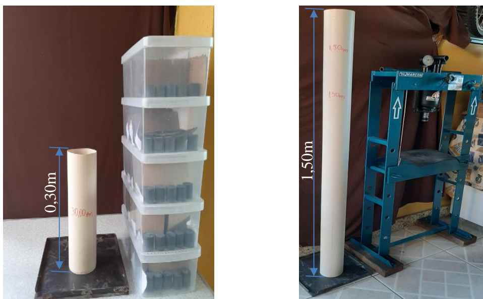
a) Aparato utilizado para ensaio de queda 0,30m
