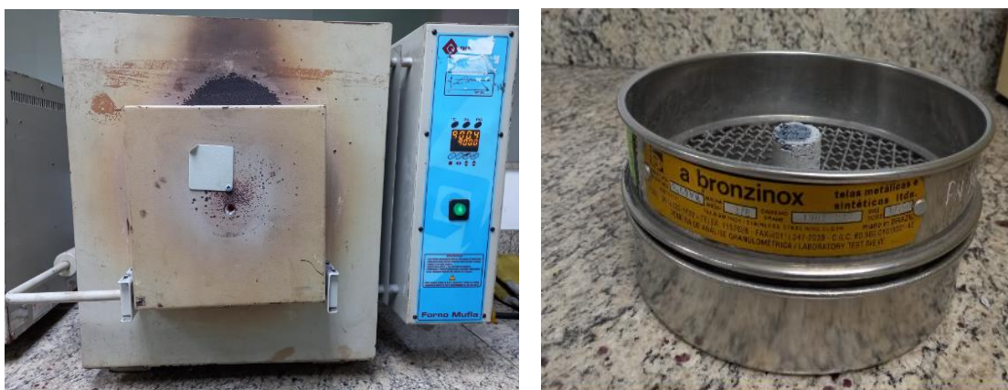
Figura 4.14 – Forno mufla e peneira utilizada nos ensaios de degradação frente à gradiente térmico.
