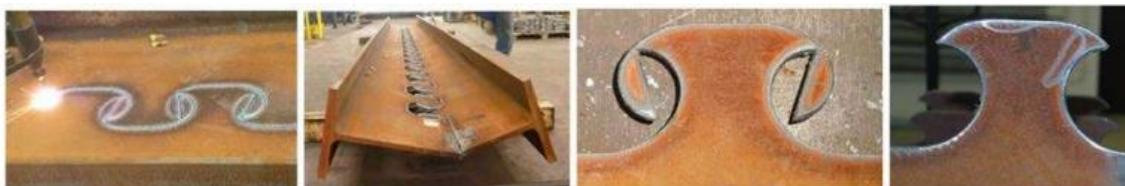
Figura 2.15: Etapas de corte de perfil de aço em formato clothoidal. Fonte: Kozuch e Lorenc (2020).
