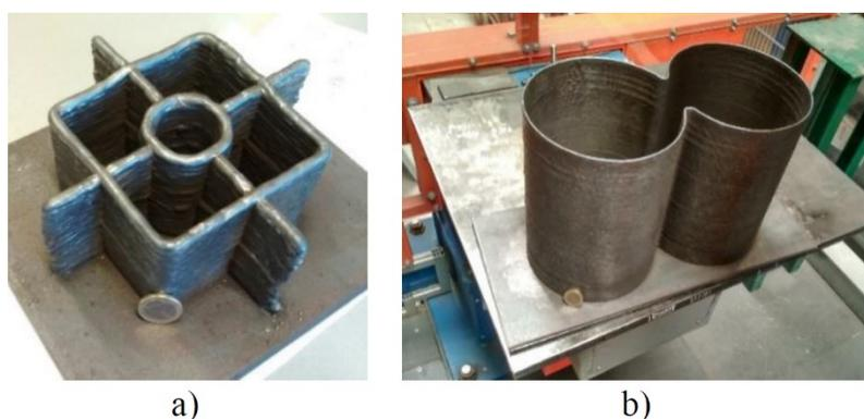
Figura 3 - Testes preliminares para validar a geometria dos cordões usando a) processo gás metal arc welding (GMAW) e b) cold metal transfer (CMT)
