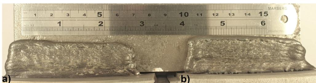
Figura 66 - Aspecto típico das paredes depositadas sem a) e com b) constrição do arco
