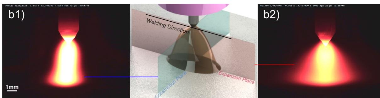
Figura 65 - Vista frontal b1) e vista lateral b2) do arco elétrico com constrição e no centro a representação esquemática das duas vistas
