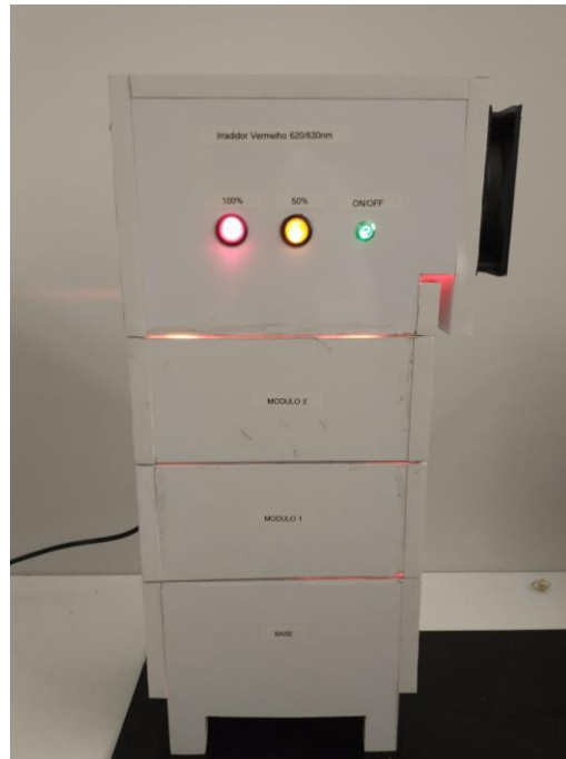
Figura 47 - Sistema de irradiação com 24 LEDs de 3 W de potência cada, com comprimento de onda na faixa de 620-630 nm. Possui ajuste de altura e potência, possibilitando 6 configurações diferentes de operação para a irradiação de placas celulares. A irradiância do arranjo de LEDs, foi medida em um potenciômetro FieldMate da marca Coherent, no comprimento de onda máximo de emissão.
