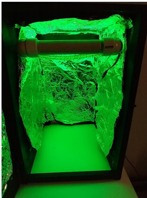
Figura 49 - Sistema de irradiação de LED para experimento de \Phi_{\Delta} .
