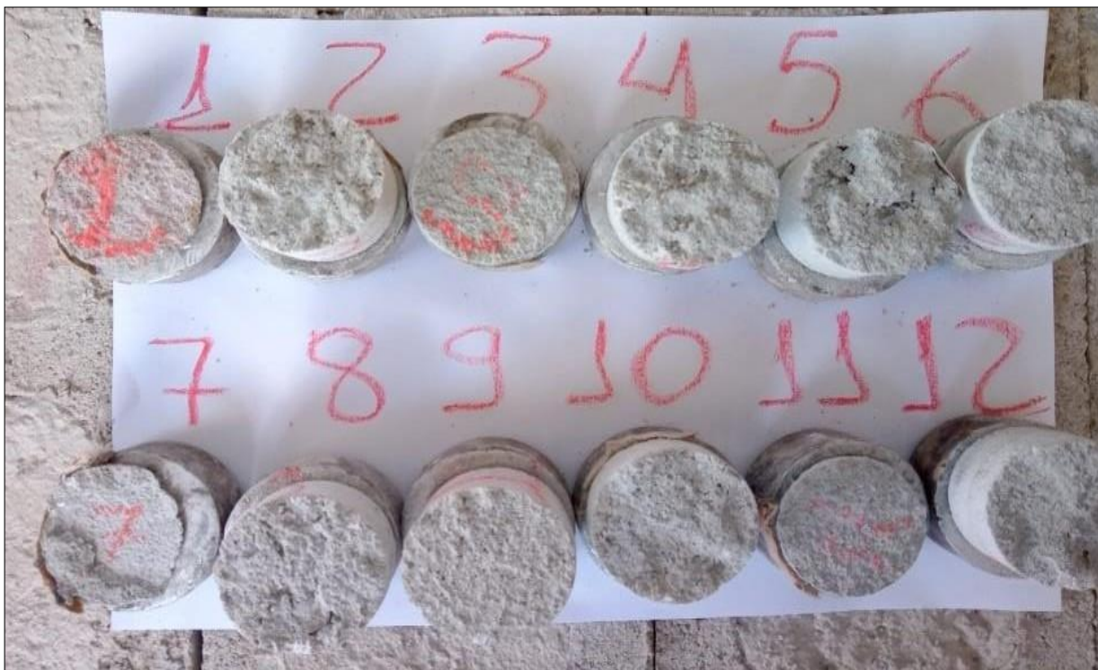
Figura 15 - Corpos de prova aos 28 dias – Sem chapisco
