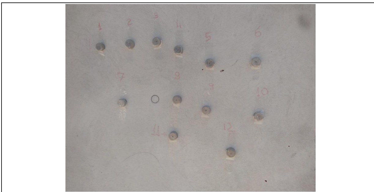
Figura 14 - Painel com pastilhas 28 dias – Sem chapisco
