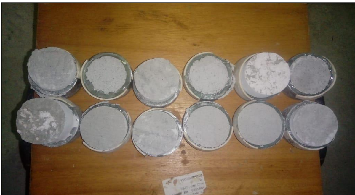
Figura 13 - Corpos de prova aos 14 dias – Sem chapisco
