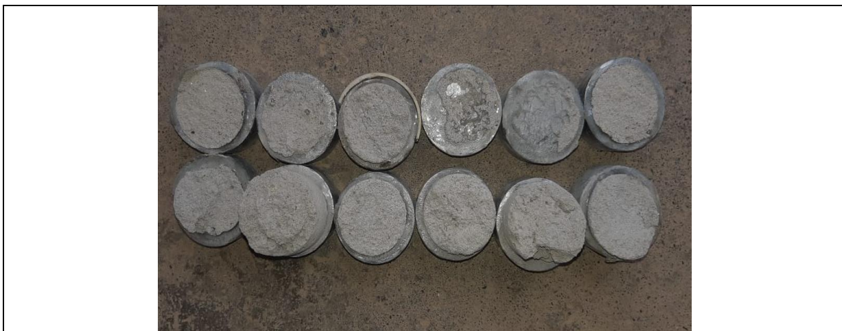
Figura17 - corpos de prova 28 dias – Com chapisco
