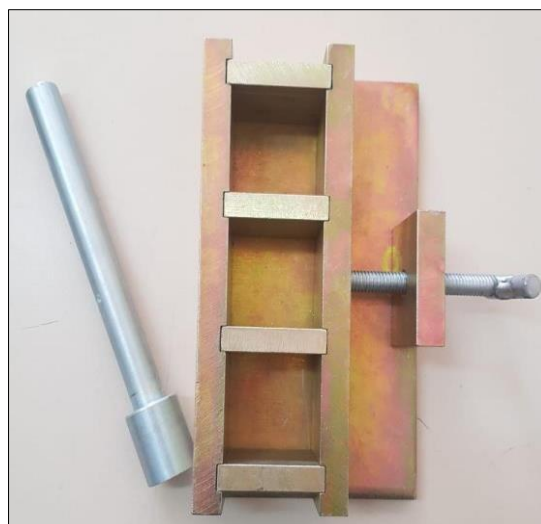
Figura 07 – Forma para moldagem
