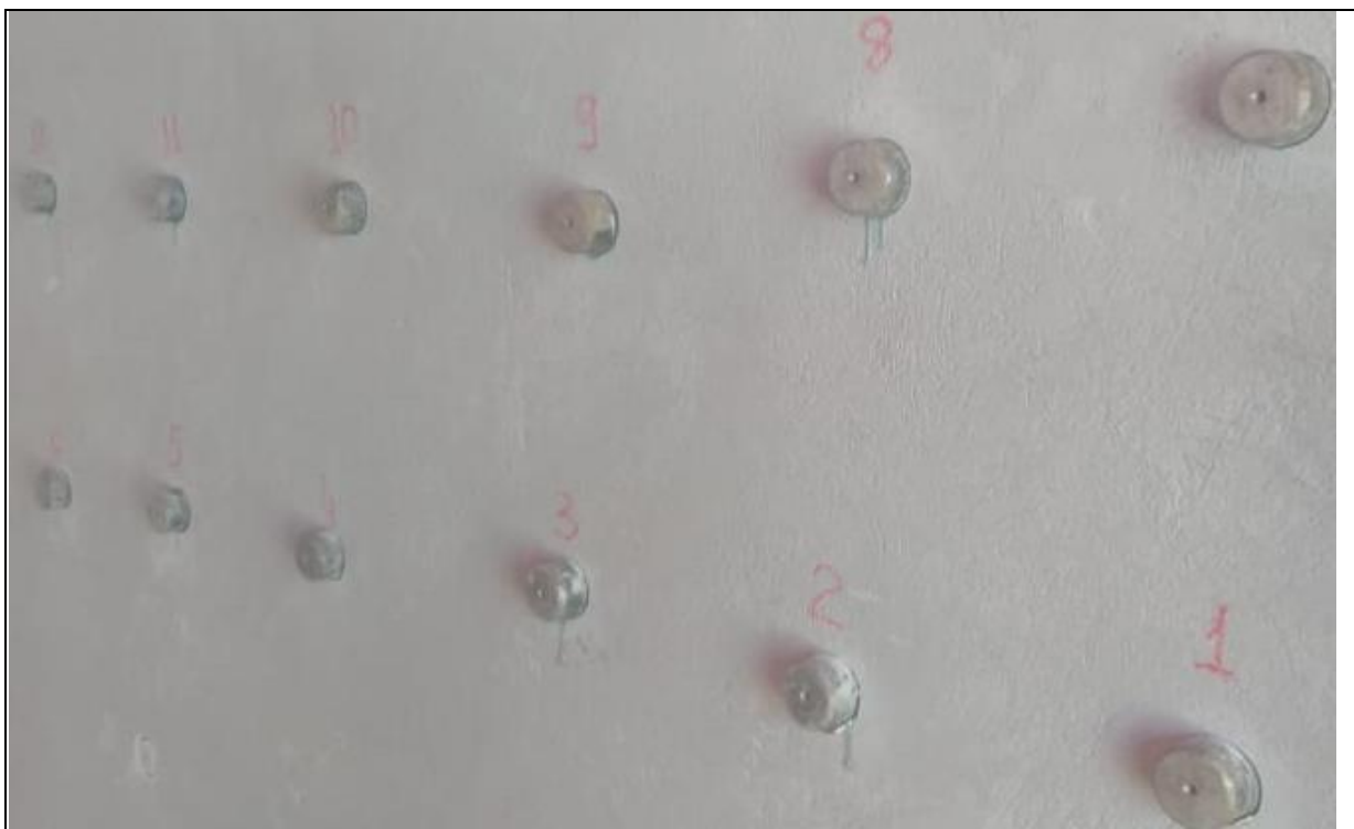
Figura 16 - painel com chapisco 28 dias
