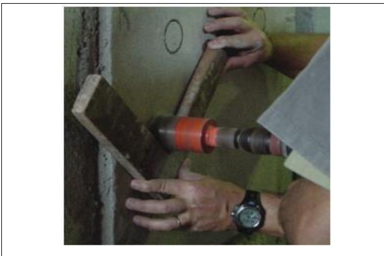
Figura 09 - Corte com serra copo, para colagem das pastilhas
