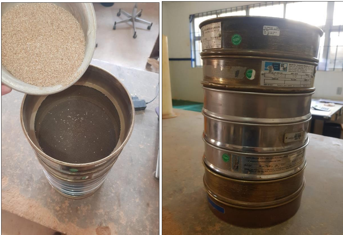
Figura 05 – Ensaio de granulometria por peneiramento
