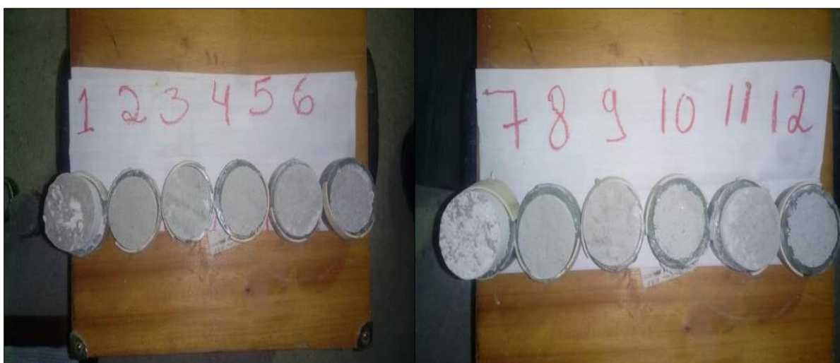
Figura 12 - Corpos de prova aos 14 dias – Sem chapisco
