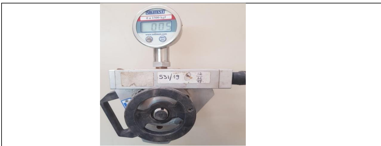
Figura 10 - Aparelho aderímetro utilizado para os ensaios de aderência
