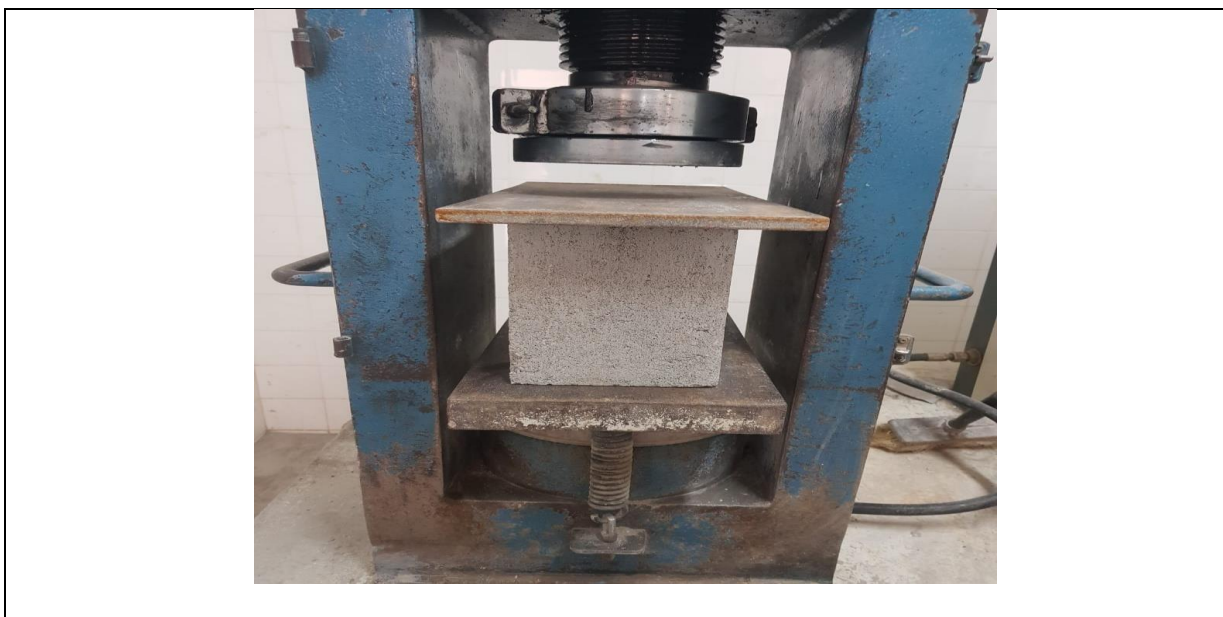
Figura 04 – Prensa para ensaios de resistência a compressão
