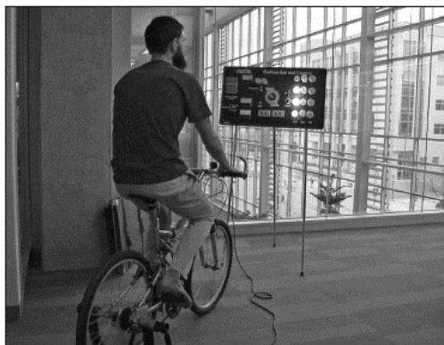
Figura 12 – Atividade experimental para verificar a eficiência de lâmpadas
