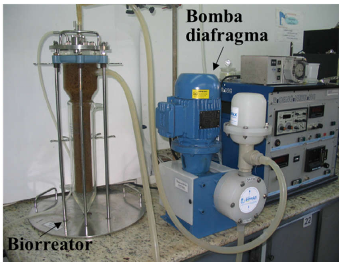
Figura 5.9 - Biorreator de leito fluidizado utilizado para a produção fermentativa de xilitol a partir de HH no estudo desenvolvido por Sarrouh (2009). Fonte: Sarrouh (2009).
