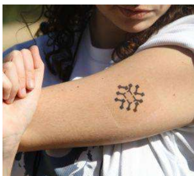
Figura 112 - Banda fitness de grafeno ( flagship ) - mede frequência cardíaca, hidratação, saturação de oxigênio, frequência respiratória e temperatura
