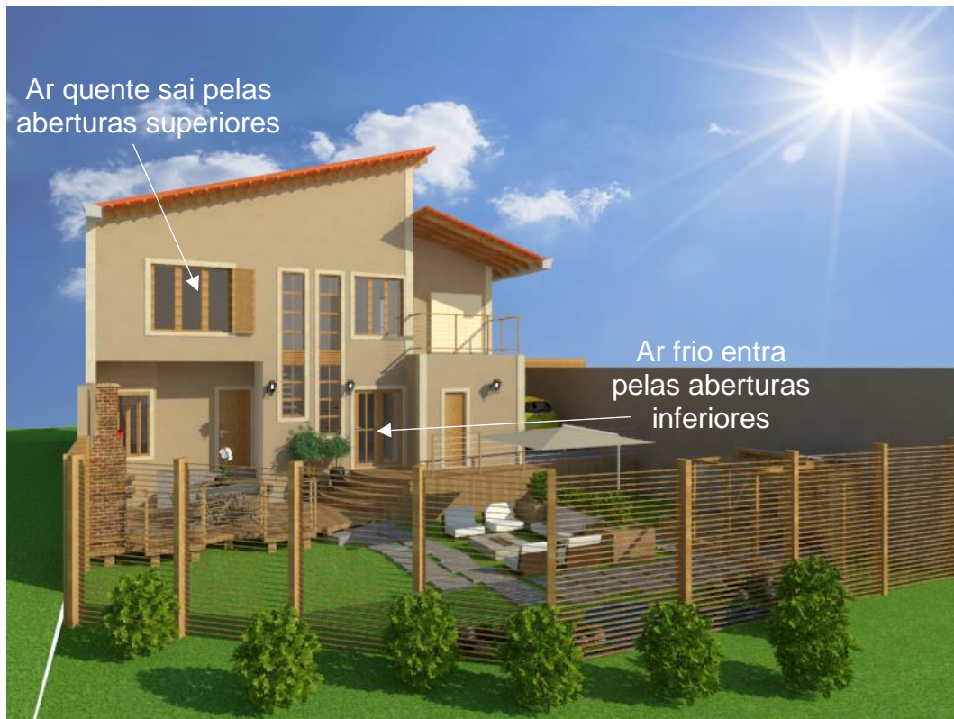
Figura 33 - Ventilação induzida na Casa
