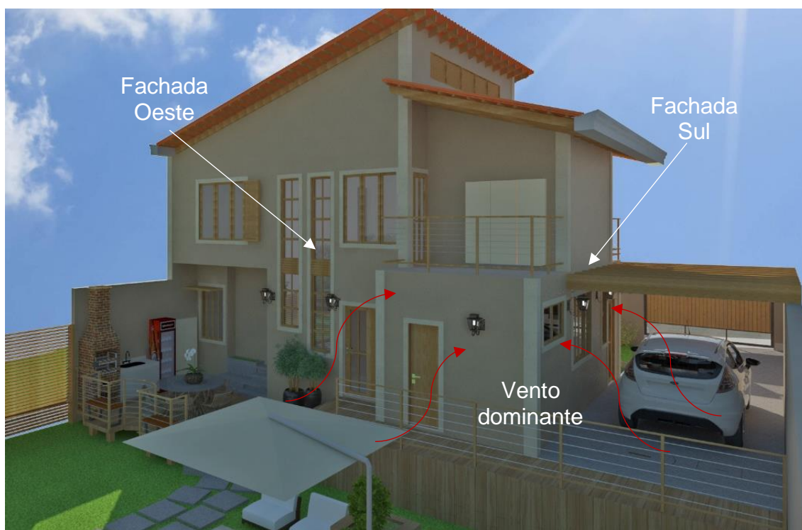
Figura 32 - Ventilação cruzada na casa
