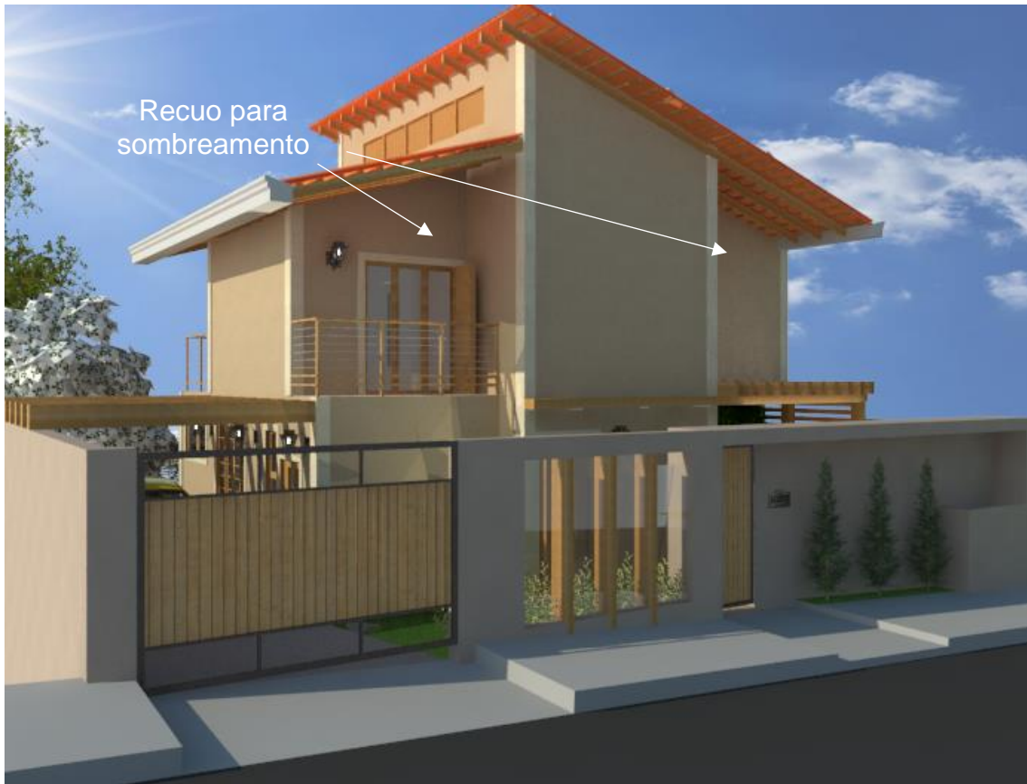
Figura 52 - Volumetria fachada leste
