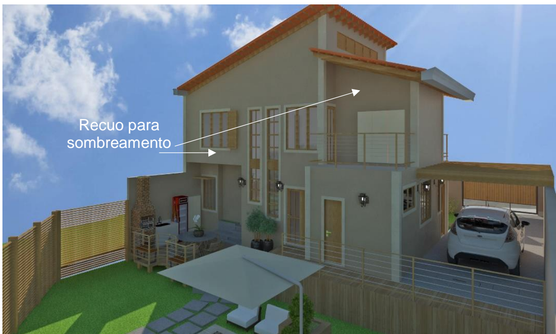
Figura 53 - Volumetria fachada oeste
