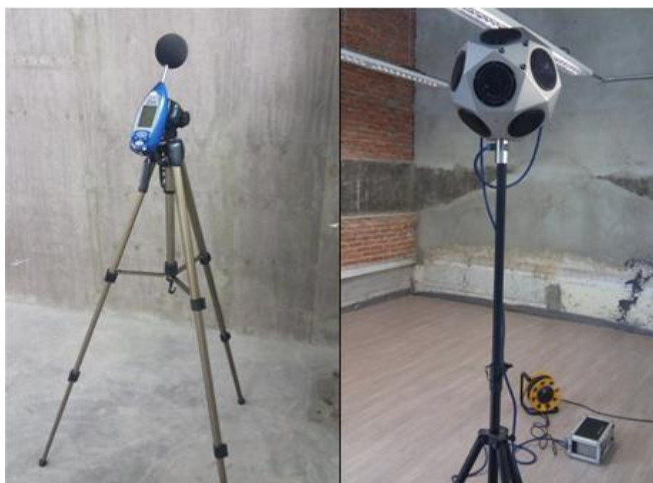
Figura 11 – Microfone e fonte sonora dodecaédrica.
