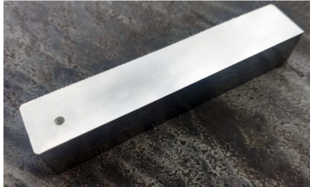
Figura 6 – Fotografia do corpo de prova utilizado nos ensaios de medição de emissividade. Material: aço AISI H13. Dimensões: 105 mm x 20 mm x 16 mm. Destaque para a superfície superior contendo furo de diâmetro de 3 mm e profundidade de 8 mm.
