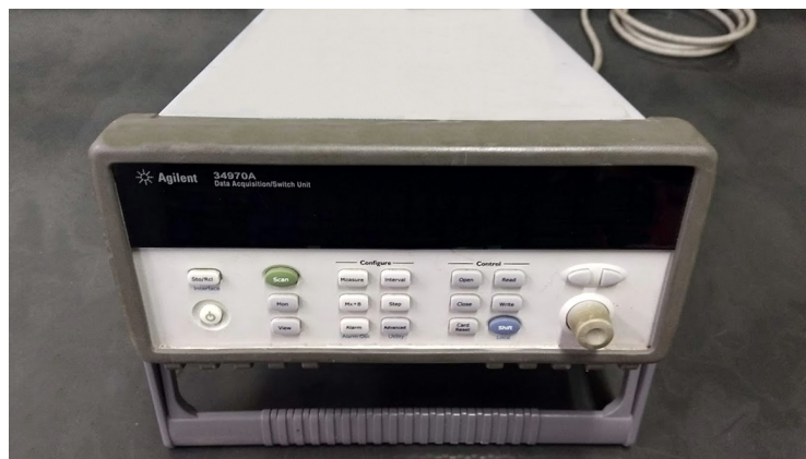
Figura 28 – Sistema de aquisição de dados utilizado para termorresistência.
