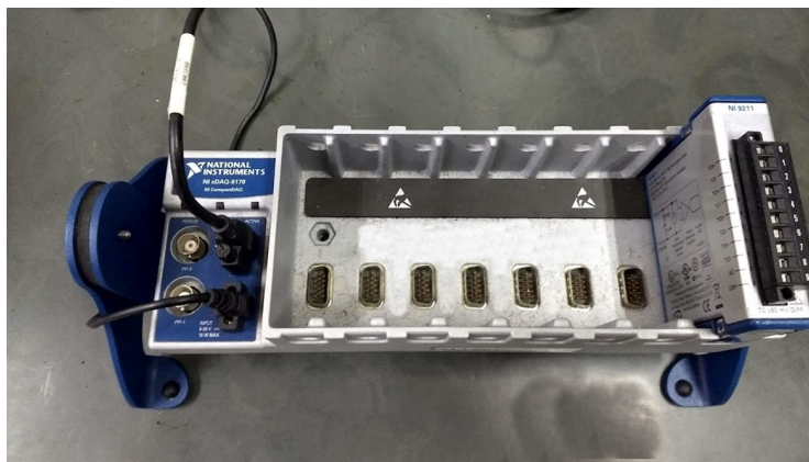
Figura 27 – Sistema de aquisição de dados utilizado para o termopar tipo T.
