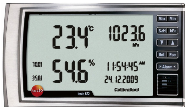
Figura 26 – Termo-higrômetro utilizado para monitoramento das condições ambientes. Fonte: Testo-SE (2009).
