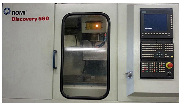
Figura 32 – Centro de usinagem ROMI Discovery 560.
