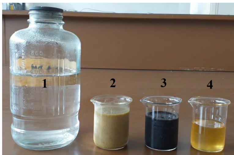
Figura 4.2 - Elementos utilizados nos sistemas de tratamento. 1: DM; 2: Trub; 3: Inóculo e 4: GB. Fonte: da autora.
