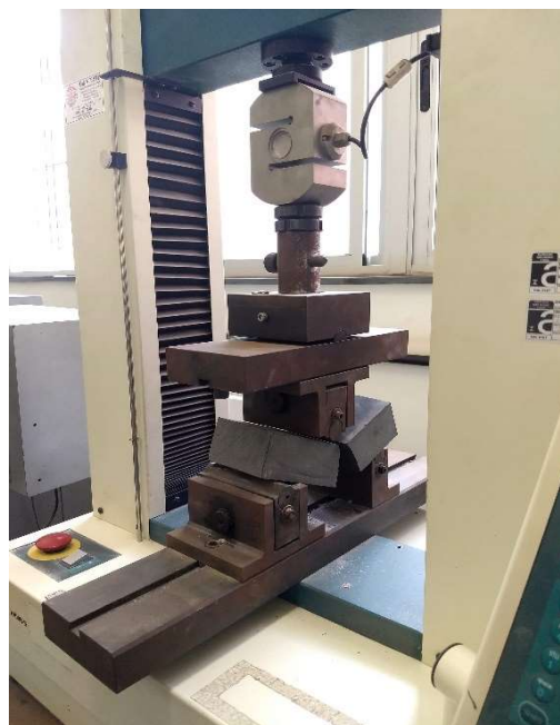
Figura 13: Detalhe da ruptura do corpo de prova na prensa de Flexão 3 Pontos
