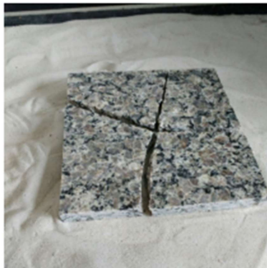
Figura 6: Detalhe da ruptura do corpo de prova
