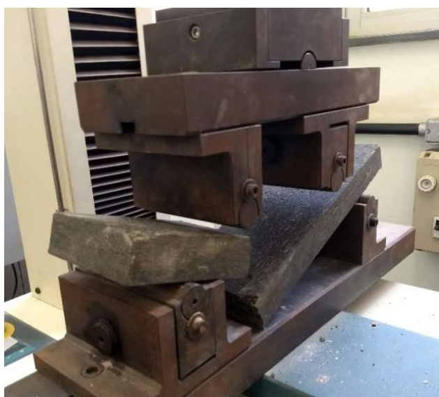
Figura 15: Detalhe da ruptura do corpo de prova na prensa de Flexão 4 Pontos
