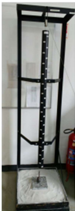
Figura 5: Equipamento utilizado para o ensaio de impacto de corpo duro
