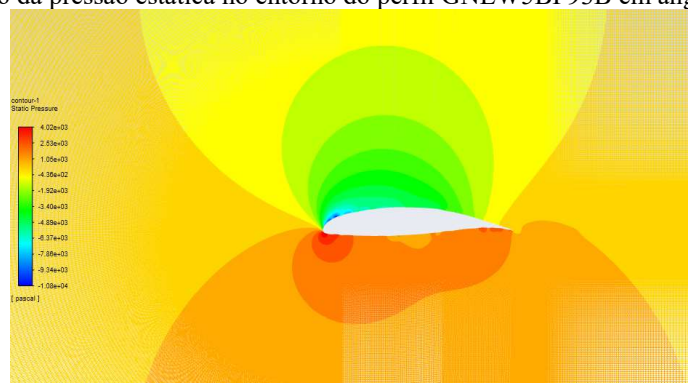
Figura 81 - Distribuição da pressão estática no entorno do perfil GNEW5BP93B em ângulo de ataque de 6 graus
