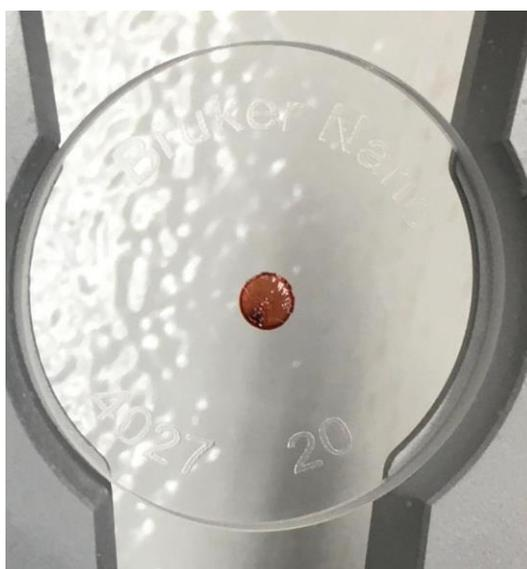
**Figura 10: Craquelamento do filme e desprendimento de suas bordas após o preparo com Triton X-100 0,5%.**
