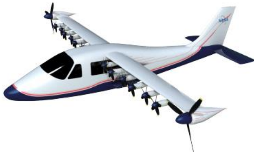
Figura 15 - O X-57 Maxwell demonstrando as duas tecnologias da configuração DEP, "sistema de hélice de alta sustentação e hélices de ponta de asa para voo de cruzeiro
