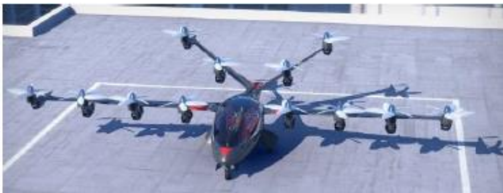
Figura 16 - Demonstração da decolagem da aeronave Joby S2 (VTOL)
