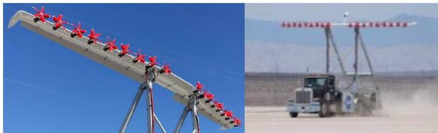
Figura 13 - Configuração da asa do LEAPTech (a esquerda), teste do Mod I SCEPTOR com hélices de alta sustentação em NASA AFRC (a direita)
