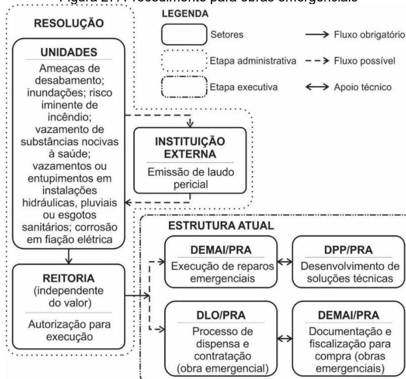
Figura 27: Procedimento para obras emergenciais
