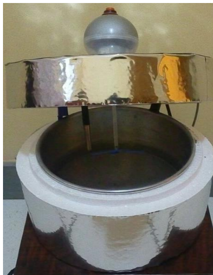
Figura 1. Vaso calorimétrico, agitador e sensor de temperatura.
