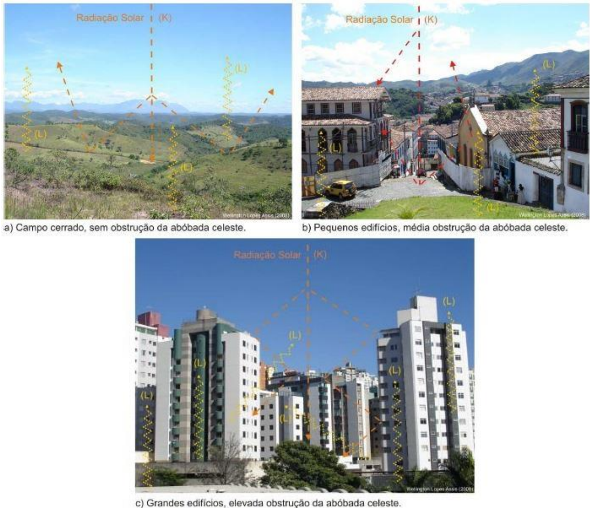
FIGURA 3: Representação simplificada dos efeitos da radiação solar sobre as superfícies verticais e horizontais, de acordo com a obstrução da abóbada celeste. As setas de cor laranja representam o fluxo de radiação em ondas curtas (K) e as setas amarelas o fluxo de radiação em ondas longas (L). Fonte: Assis (2010).
