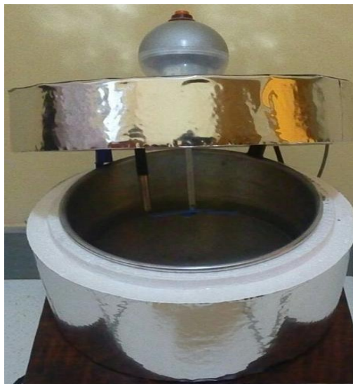
Figura 1 – Vaso calorimétrico, agitador e sensor de temperatura .
