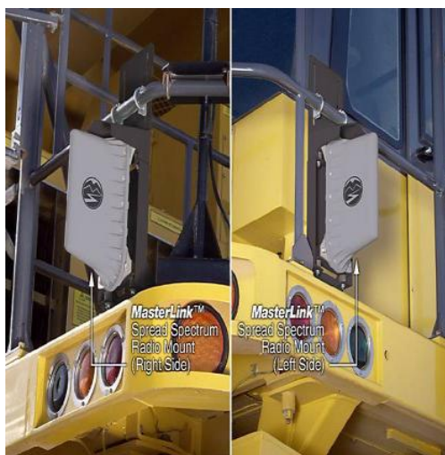
Figura 13 - Rádio antena instalada na lateral dos equipamentos.
