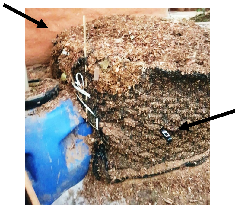
FOTO 43 - Medindo temperatura de composto de bioaquecimento – sítio Larboratório. A seta à esquerda aponta para o composto (equipamento de bioaquecimento) e a seta à direita aponta para um termômetro inserido no composto.
