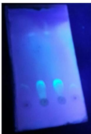
**Figura 16** - Cromatografia em camada delgada do extrato hidroetanólico e do sólido precipitado do extrato hidroetanólico da semente do abacate em sílica gel tendo acetato de etila / ácido acético / água (20:1,8:3,2 v/v/v) como fase móvel e revelação sob radiação ultravioleta após aplicação do revelador NP/PEG
