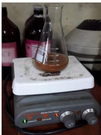
**Figura 8** - Suspensão do pó da semente de abacate em solução de etanol 70% v/v sendo agitada em agitador magnético
