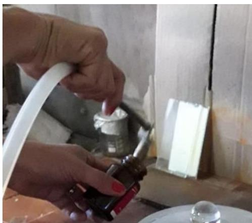
**Figura 11** - Aplicação dos reveladores na placa N° 3
