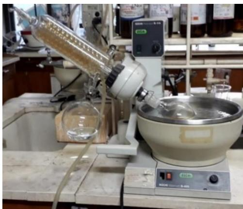
**Figura 10** - Evaporador rotativo para remoção do solvente
