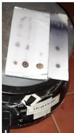
**Figura 18** - Cromatografia em camada delgada do extrato hidroetanólico da semente do abacate em sílica gel tendo clorofórmio / metanol / água (16:2,4:0,4 v/v/v) como fase móvel após revelação com solução de vanilina-ácido perclórico, tendo-se a visualização das manchas na placa N° 4, à direita
