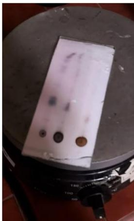
**Figura 15** - Cromatografia em camada delgada do extrato hidroetanólico e do sólido precipitado do extrato hidroetanólico da semente do abacate em sílica gel tendo clorofórmio / metanol / água (16:2,4:0,4 v/v/v) como fase móvel após revelação com solução de anisaldeído-ácido sulfúrico
