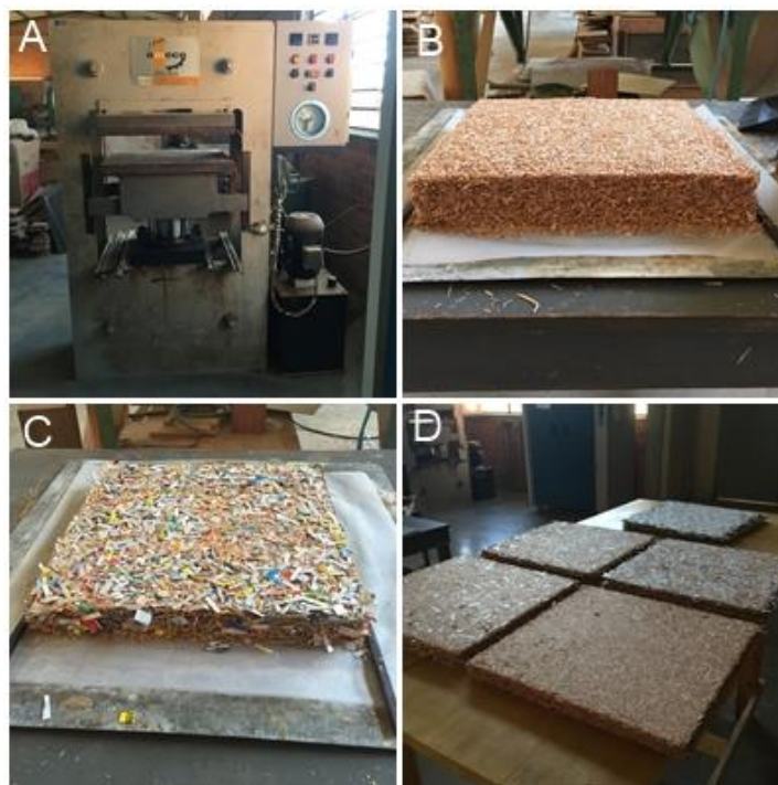
Figura 1. (A) prensa hidráulica utilizada para prensagem a quente; (B) formação do colchão com partículas de madeira; (C) formação do colchão com partículas de embalagens cartonadas; (D) painéis formados, lixados e prontos para aclimação, evidenciando todos os tratamentos.
