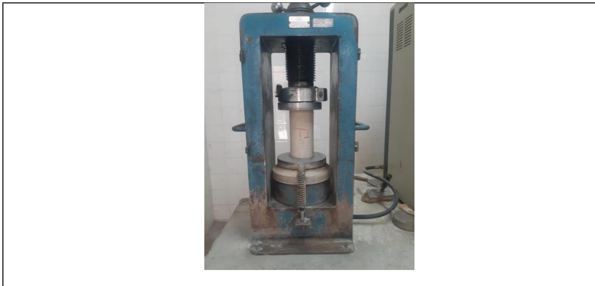
Figura 14: Rompimento de corpo de prova
