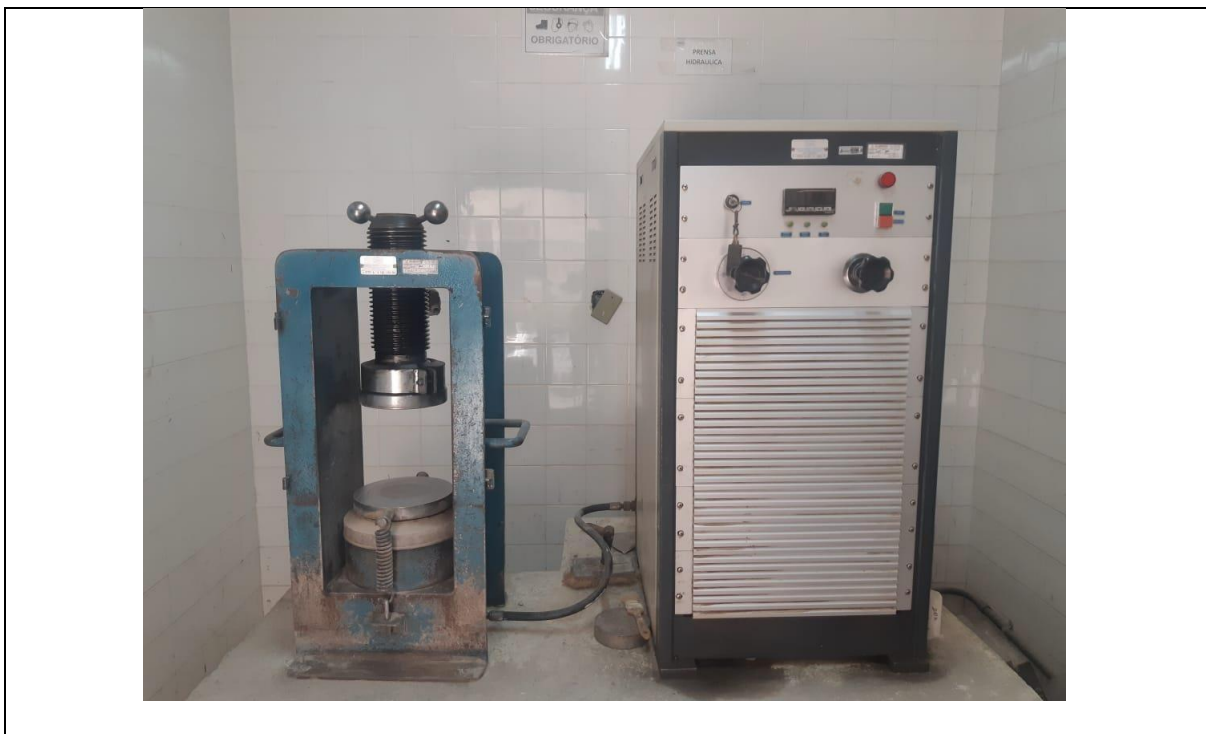
Figura 12: Prensa hidráulica de concreto
