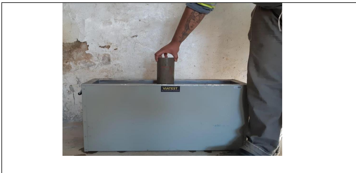
Figura 08 - Tanque com água saturada com cal hidratada
