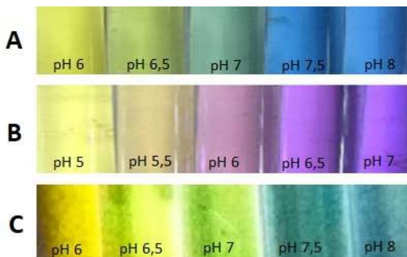
**Figura 17 – Padrão de cores para os corantes Azul de Bromotimol e Púrpura de Bromocresol em diferentes valores de pH.** Em A, soluções tamponadas padrão de Azul de Bromotimol (0,1%) com valores de pH de 6 – 8. Em B, soluções tamponadas padrão de Púrpura de Bromocresol (0,1%) com valores de pH de 5 – 7. Em C, soluções padrão do corante Azul de Bromotimol (0,1%) em soro humano, valores de pH de 6 – 8.
