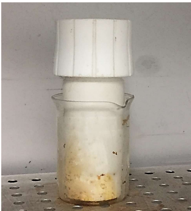
Figura 13 - Vazamento observado durante a etapa de cristalização em autoclave adaptada revestida de Teflon, a partir das manchas cor âmbar no béquer. Fonte: elaborado pela autora.
