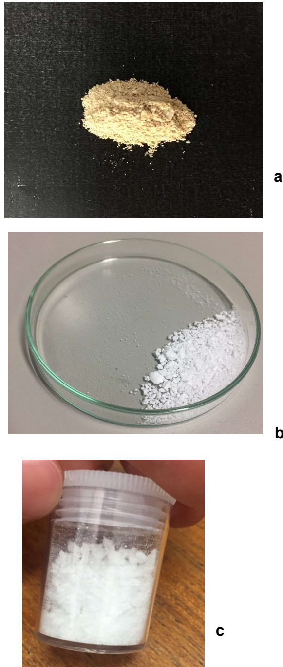
Figura 12 – Amostras de zeólitas sintetizadas. (a) silicalite-1; (b) ZSM-5 com TPAOH; (c) ZSM-5 com CTAB. Fonte: Elaborada pela autora.
