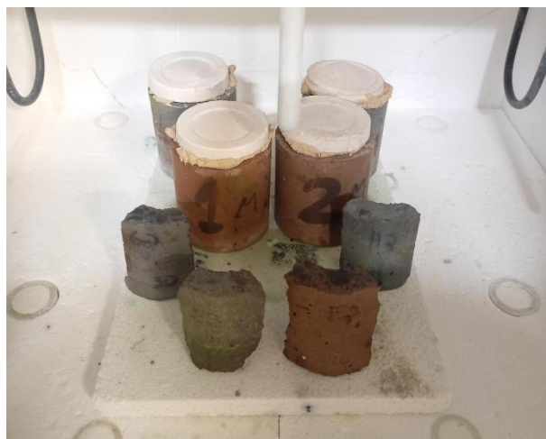
Figura 13 – Disposição dos corpos de prova no forno. Fonte: (AUTORIA PRÓPRIA).
