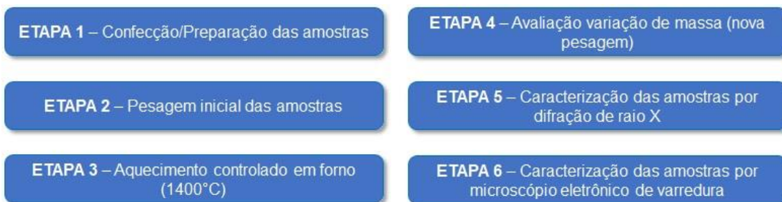
Figura 9 – Fluxograma do planejamento dos experimentos. Fonte: (AUTORIA PRÓPRIA).
