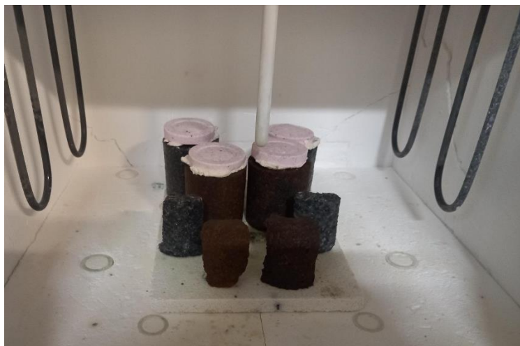
Figura 14 – Corpos de prova após processo de aquecimento e resfriamento dentro do forno. Fonte: (AUTORIA PRÓPRIA).
