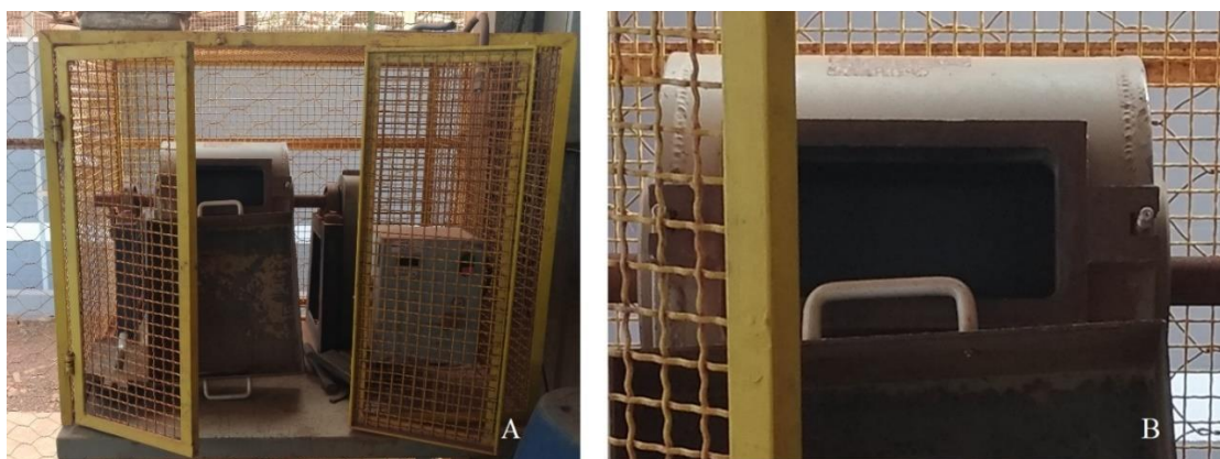
Figura 3.6. Moinho utilizado. Em A, aspecto geral do moinho de bolas. Em B, detalhe do moinho.
