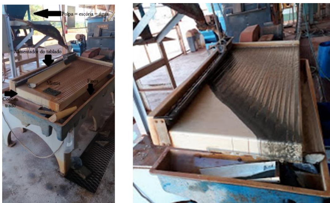
Figura 3.10. Mesa concentradora utilizada (marca/modelo Humphreys/Carpco).
