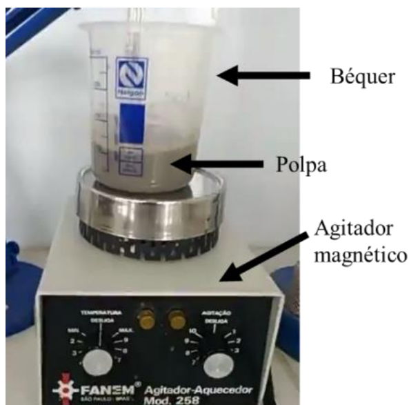
Figura 3.16. Agitador magnético e béquer utilizado. Pode-se observar a polpa dentro deste.
