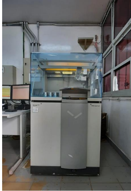
Figura 3.9. Equipamento de FRX utilizado (Marca/Modelo Axios/PanAnalytical).
