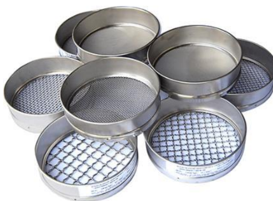
Figura 2.8. Visualização da quantidade de aberturas por polegada (mesh) de algumas peneiras (CONTROL LAB, 2020).
